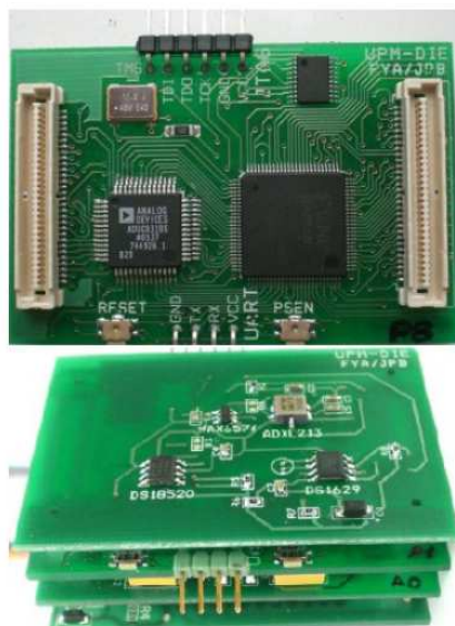
Figura 2.34 Placa con el Microcontrolador y PFGA junto con los módulos de acondicionamiento (Portilla et al. 2008).
