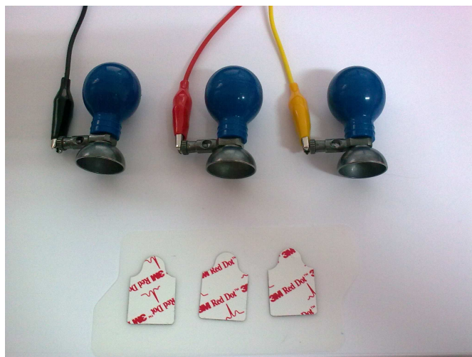
Figura 5.21 (Arriba) Electrodo metálicos de succión. (Abajo) Electrodo adhesivos 3M.
