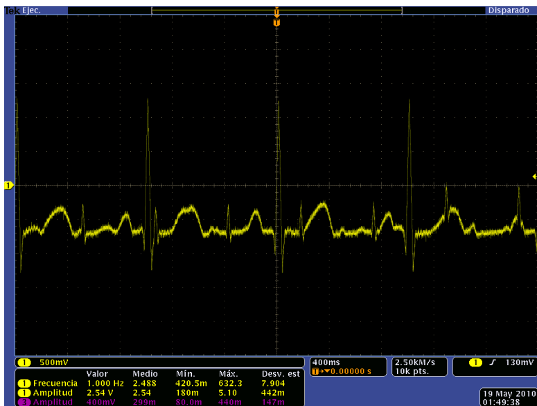
Figura 5.25 ECG Materno y fetal simulados y procesados en la FPAA
