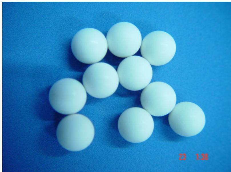
Figura 8. 10 bolas de oxido de zirconia.
