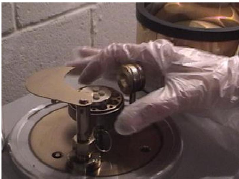
Figura 15. Sistema de atomización catódica marca DENTON VACUUM modelo DESK II.
