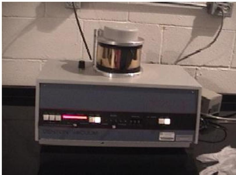
Figura 16. Recubridora de Metales SPUTTERING, Marca DENTON VACUUM, Modelo DESK II.
