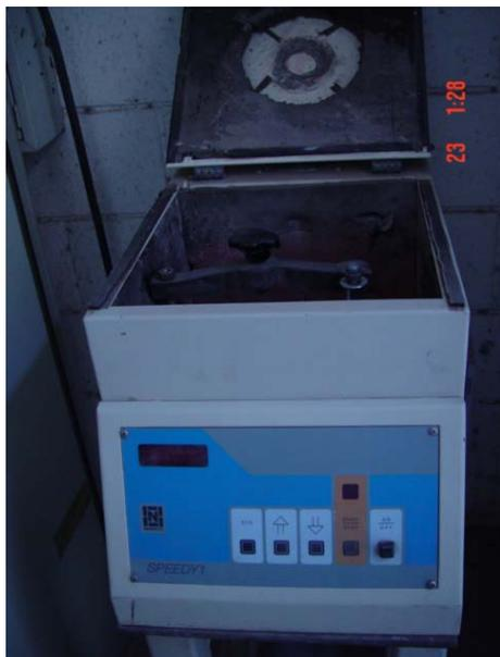
Figura 18. Molino planetario.
