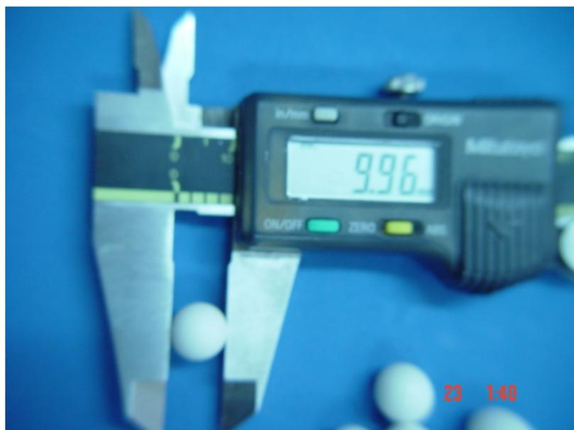
Figura 9. Bolas de oxido de zirconia de 9.96mm de diámetro.
