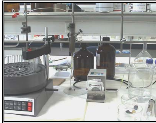
Figura 5.16 - Vista del montaje utilizado para la realización de las experiencias en columna en lecho saturado
