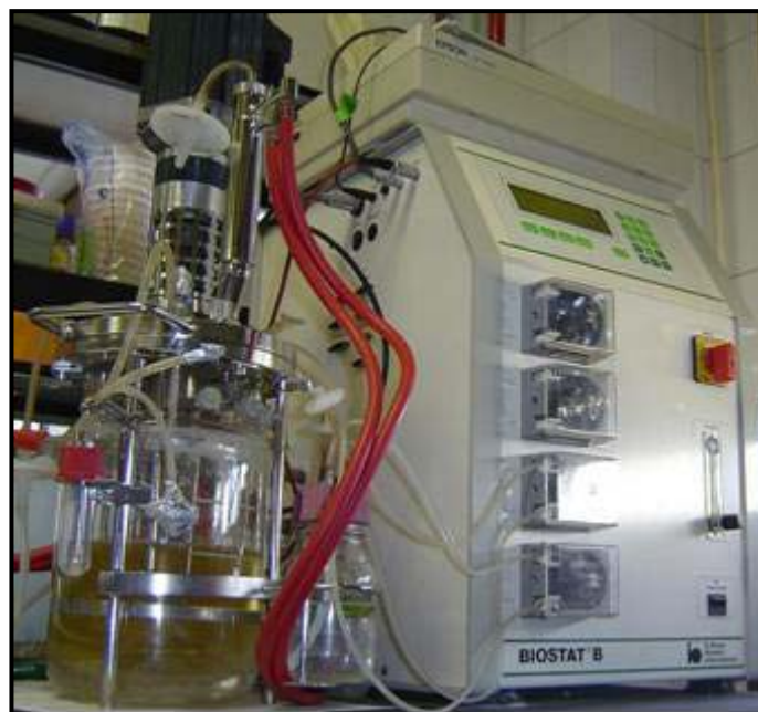
Fig.14 Fermentador Biostat B en el que se cultivó P.jamilae CECT 5266
