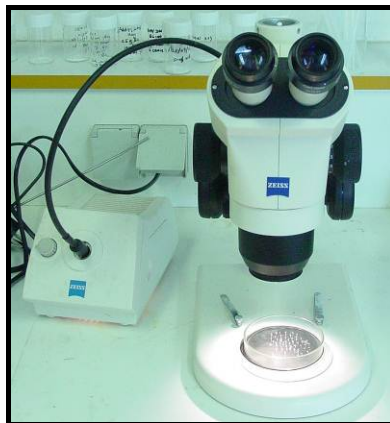
Fig. 19 Microscopio estéreo para la toma de imágenes de perlas
