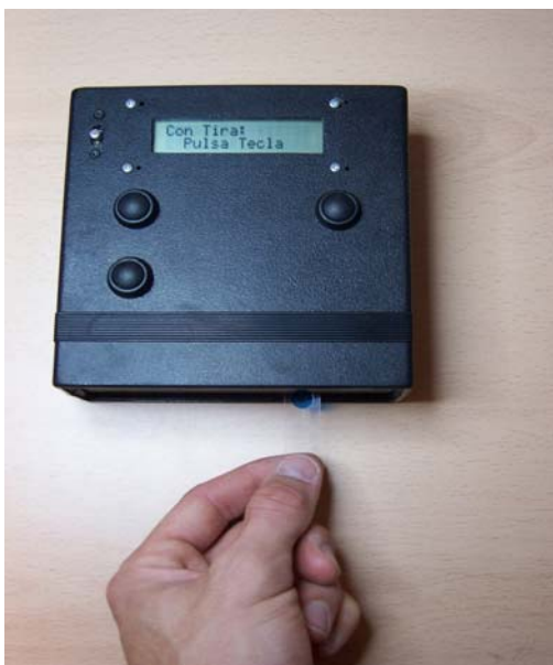
Figura 4.7. Fotografía de la instrumentación portátil mostrando cómo situar el sensor desechable.
