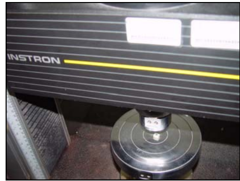
Figura 13. Análisis de compresión directa pruebas de resistencia a la compresión en las platinas de la máquina Instron.
