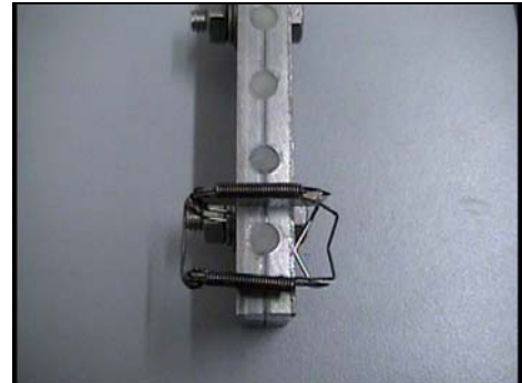
Figura 4. Composite aislado en los moldes con 5 cavidades de 1mm a 5mm para un fotocurado individual.
