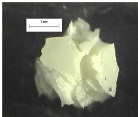
Figura 14. Muestra de un composite fracturado por compresión directa en la máquina Instron 4469, a la cual se le observa el punto de fractura y desplazamiento del material .
