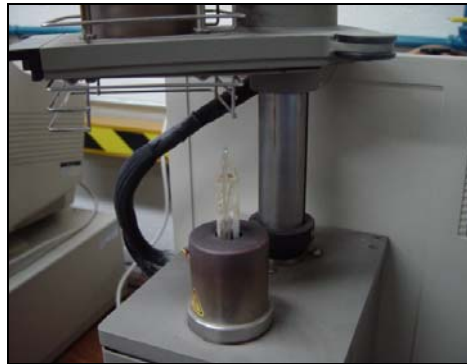
Figura 19. Probeta de la analizadora TMA 2940 utilizada para analizar la distorsión se colocan las muestras de composite.
