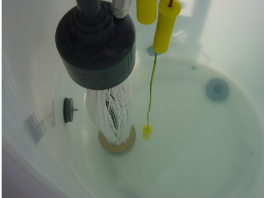
Figura 3.6. Módulo de Membrana y controladores de nivel.
