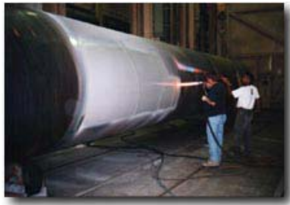
Figura 3. Proyección térmica de una tubería.
