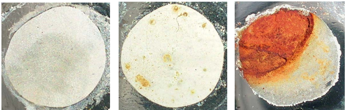
Figura 22. Superficie de los recubrimientos después de 2 semanas de inmersión en NaCl 0.06 M.
