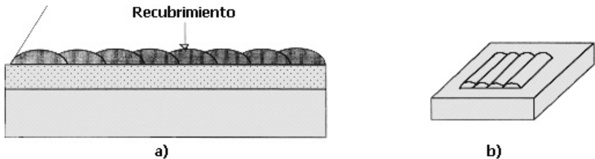
Figura 8. a) Sección transversal de un recubrimiento obtenido por plaqueado láser. b) Superficie recubierta mediante superposición de cordones individuales.
