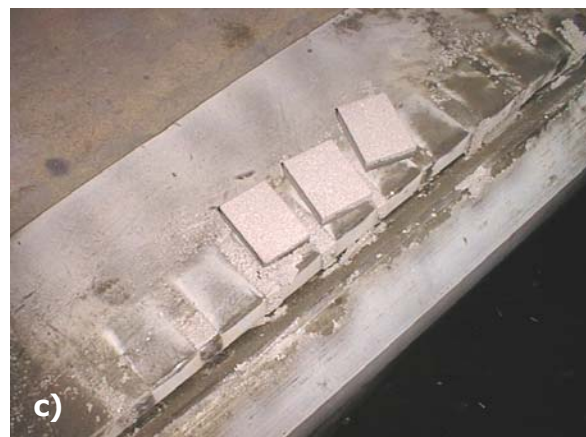
Figura 3. Imágenes del proceso de proyección por combustión a la llama a baja velocidad: a) pistola empleada, b) deposición, c) aspecto final.
