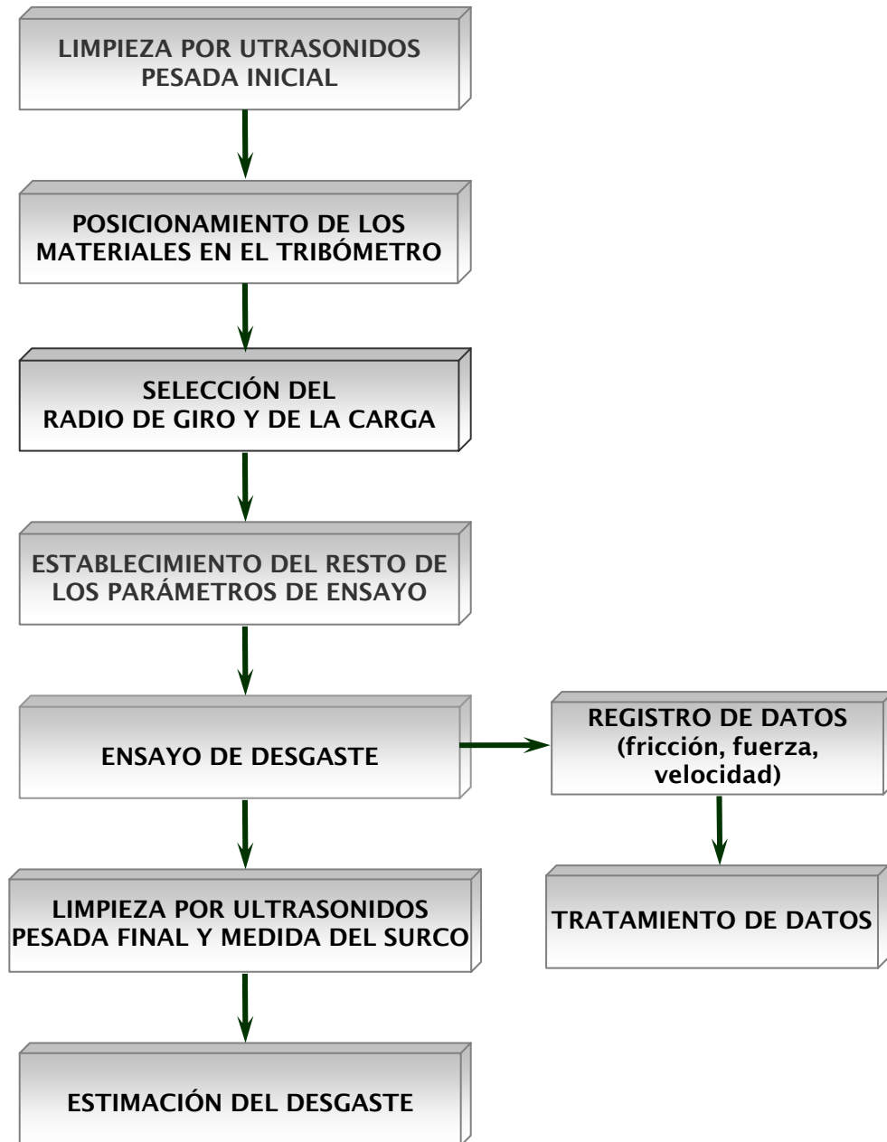
Figura 10. Esquema del procedimiento seguido en un ensayo de desgaste.
