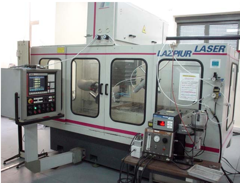
Figura 5. Fotografía del sistema láser y de la unidad automática de control del proceso empleados.
