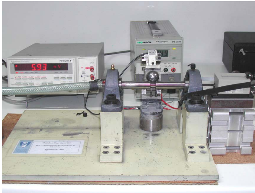
Figura 12. Máquina de desgaste abrasivo a escala micro esfera-sobre-placa.
