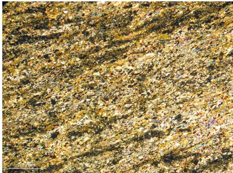
**Lámina 3.** Caliza micrítica recristalizada a espática. Foto a con sólo polarizador. Foto b con polarizador y analizador cruzados.
