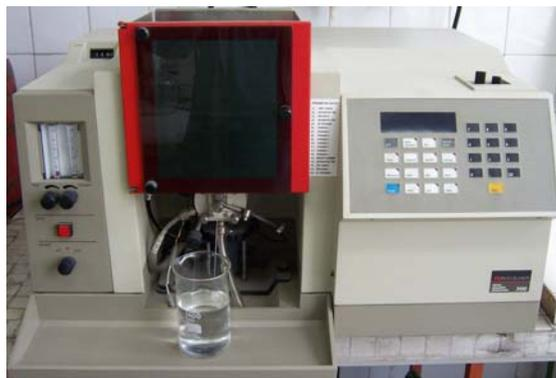
Espectrofotómetro modelo 3100 de Perkin-Elmer
