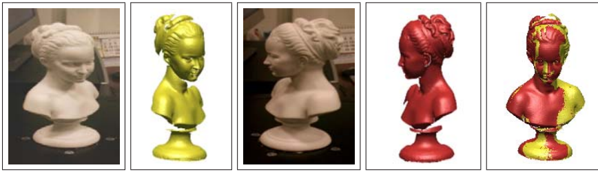
Figura 4.4: Ejemplo de adquisición y registrado de dos imágenes de rango correspondientes al busto en escayola de una mujer
