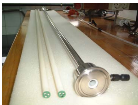
Figura 5.5 Módulo de filtración
