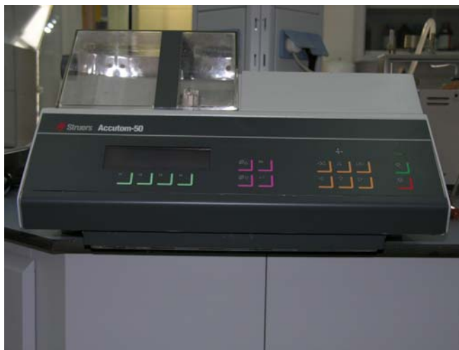
Figura 3.1.: Micrótopo utilizado par acortar las barras de titanio.
