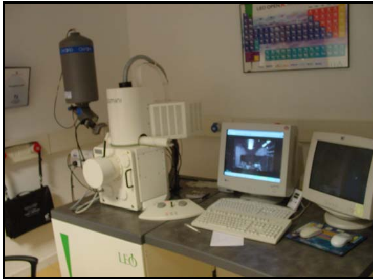
Figura 3.9.: Microscópio de alta resolución modelo Gemini fabricada por LEO Alemania.
