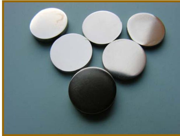
Fig. 3.4.: Discos de titanio después del tratamiento de pulido
