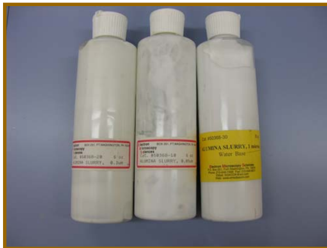
Fig. 3.3.: Partículas de aluminio utilizadas en el ultrapulido
