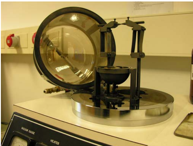
Fig. 3.14.: Máquina Para el recubrimiento con carbon de las muestras previo a la lectura con microscopio electrónico.
