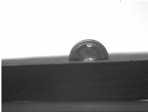
Fig. 3.8.: Medición del ángulo de contacto en una de las superficies estudiadas.
