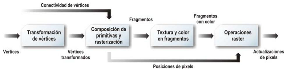
Figura A-4. Pipeline de renderizado en la GPU moderna. Este esquema básico describe tanto a la GPU de pipeline fijo como a la de pipeline programable.
