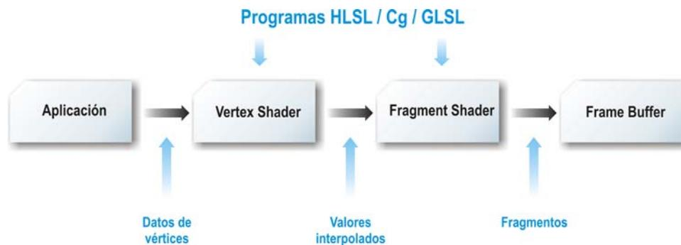
Figura A-8. Integración de los shaders en el pipeline de rendering.
