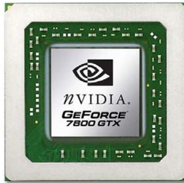
Figura A-1. Detalle de una GPU GeForce 7800GTX.
