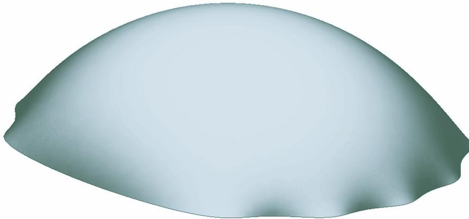
**Figura 4.1:** Forma de una gota sésil sobre una superficie heterogénea a bandas, obtenida mediante simulaciones con *Surface Evolver*.
