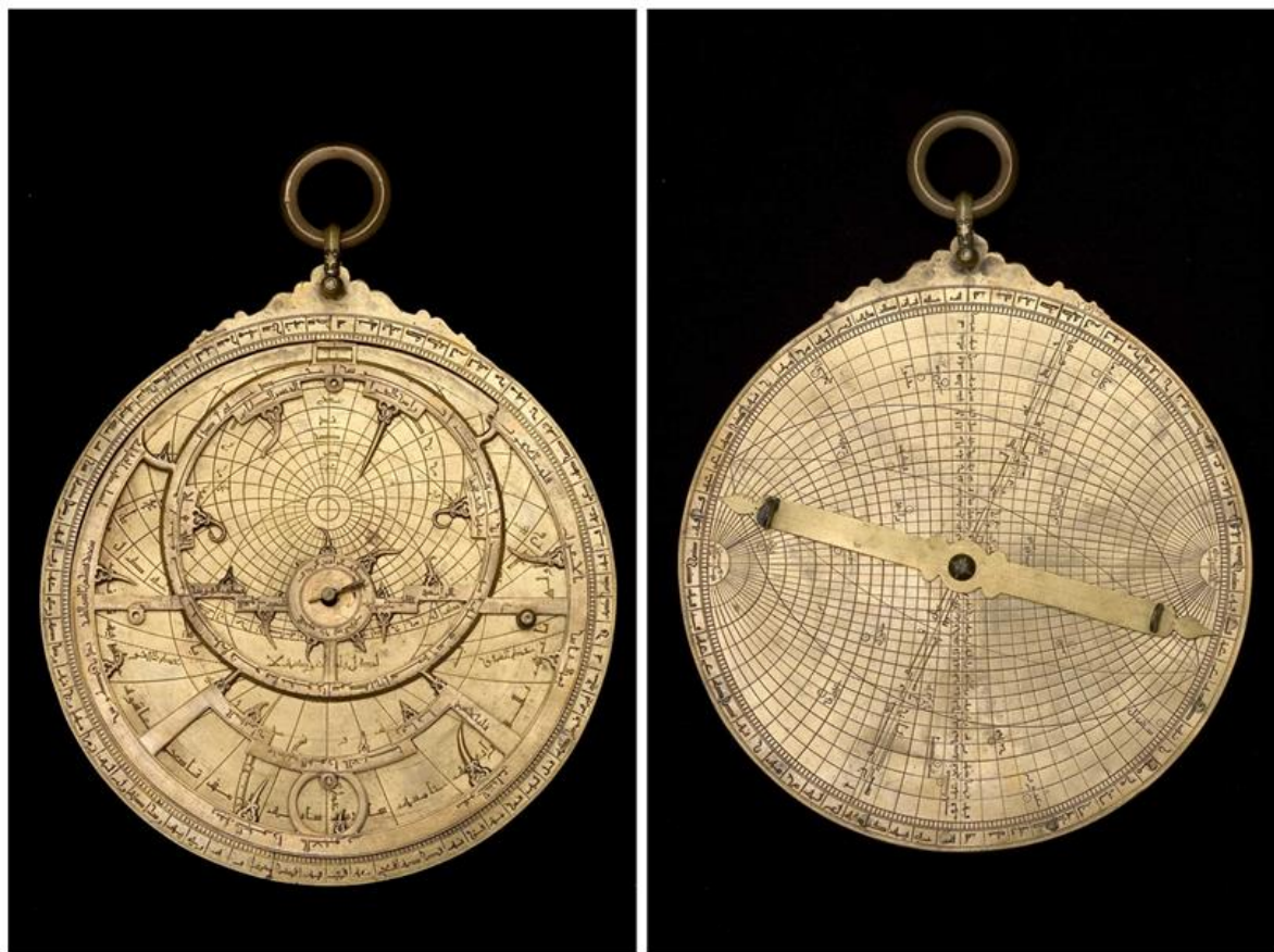
Astrolabio universal del siglo XIII confeccionado de acuerdo con la doctrina de Azarquiel. Procede del norte de África. Las estrellas de la araña se fijan a través de sus coordenadas eclípticas: latitud y longitud. Museum Science History . Oxford.
