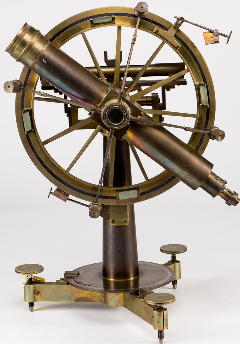
Círculo repetidor de Gambey
