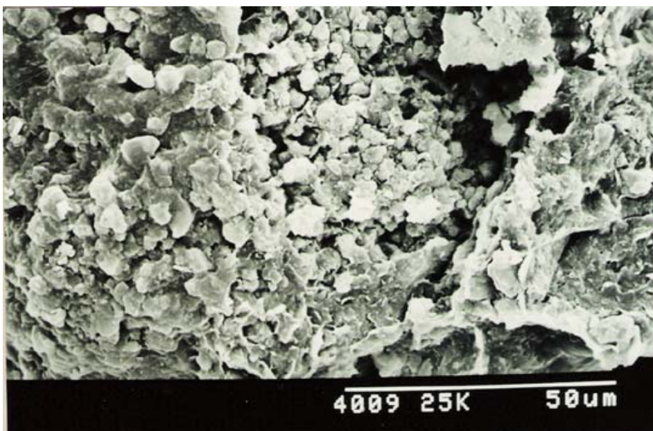
Fig.XII.22. (880x). Horizonte Bt/Ck de T2. Transición entre fábrica esquelética y zonas de piel de arcilla.
