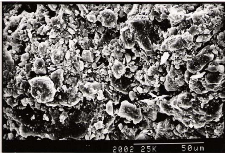
Fig.X.40. (2200x). Horizonte Bwk1 de T4. Áreas del interior del microped con fábrica esquelética interna. Esta fábrica, parecida a la exterior, muestra no obstante una mejor jerarquización (clusters aproximadamente a 100 y 50 \mu\text{m} ) y, en general, una cementación notablemente menor.
