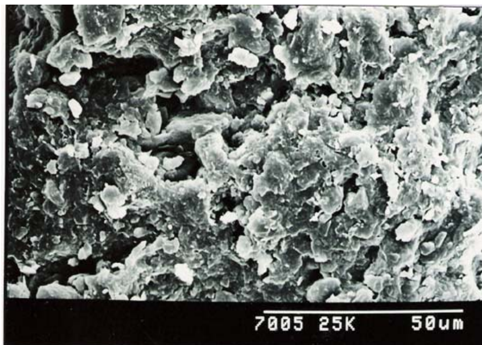
Fig.XII.12. (1200x). Horizonte Btg de T2. Fábrica laminar discontinua . Se observan clusters discoidales de 100 \mu\text{m} que rompen a dos niveles inferiores de 50 y 20-30 \mu\text{m} (nivel primario).
