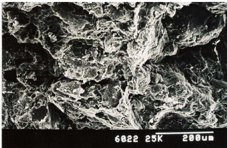
Fig.XII.24. (x). Horizonte Bt1 de T3. Fábrica laminar discontinua del exterior del microped. Se observa el aspecto deteriorado (probablemente por ruptura y desmantelamiento) de la piel de arcilla.
