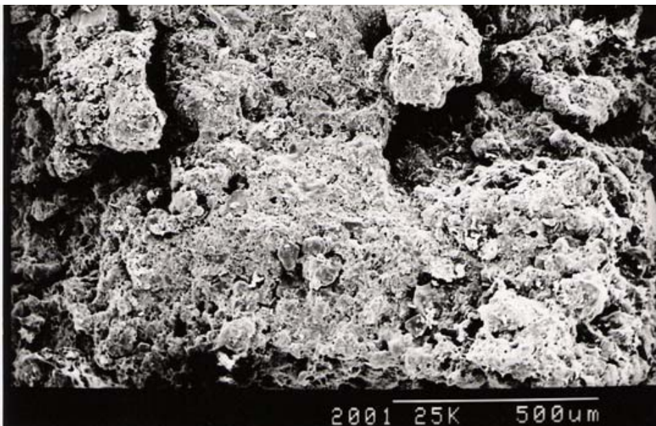
Fig.X.38. (90x). Horizonte Bwk1 de T4. Aspecto superficial de los micropeds, de forma redondeada. Nótese la espesa cementación, con toda probabilidad de naturaleza carbonatada.
