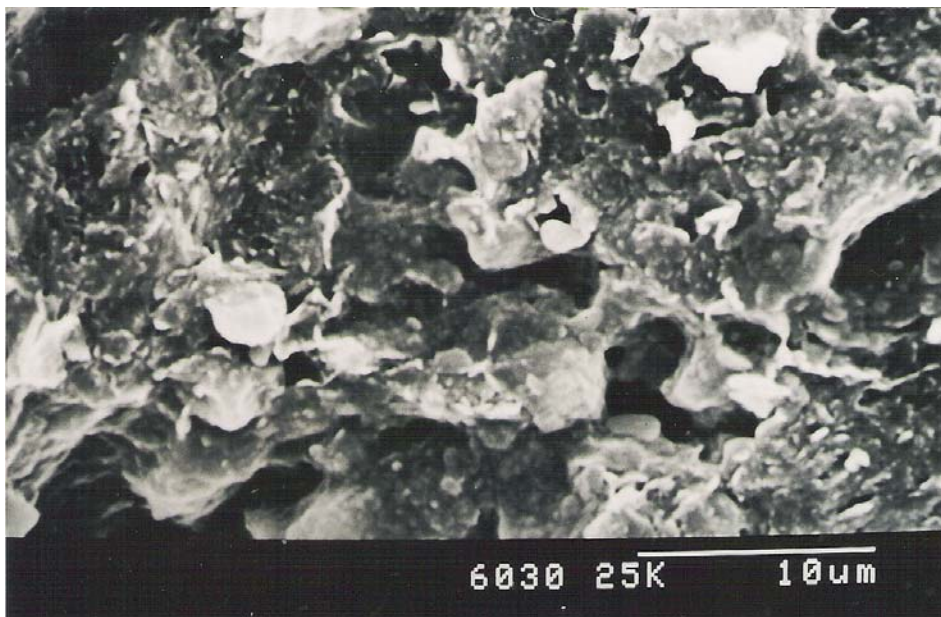
Fig.XII.27. (x). Horizonte Bt1 de T3. Fábrica matriz isotrópica del interior de los micropeds a nivel de dominios de un tamaño entre 10 y 20 \mu\text{m} , constituidos por intercrecimientos de láminas de arcilla.
