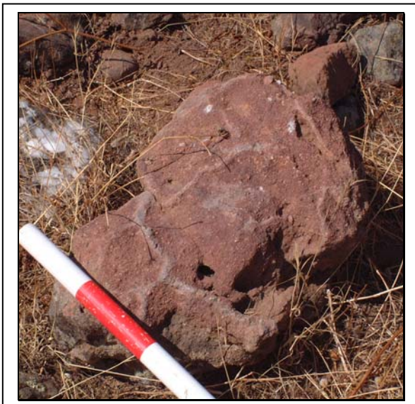
Fig. 248: Zona de brechas con fracturas rellenas por cuarzo y calcita, brechas al interior del intrusivo de la zona en Navamorquín, muestra obtenida en el margen derecho del arroyo de Murquigüelo 0,5 Km. antes de su desembocadura en el embalse del Rumblar.
