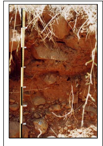
Fig. 225: Aluviones holocénicos de muy poca potencia y vinculado a arroyos de flujo esporádico, presenta intercalaciones de conglomerados con niveles arcillosos, los cantos que lo componen son de composición litológica similar a las rocas que lo rodean. o que lo subyacen. Depósito ubicado en la zona de la Nava de Andujar, drenaje vinculado al arroyo de Andújar
