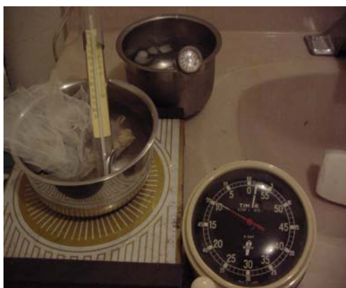
Termociclado de 500 ciclos en temperatura de 5^{\circ} \pm 2^{\circ} \text{C} y de 55^{\circ} \pm 2^{\circ} \text{C} con 10 seg. de intervalo
