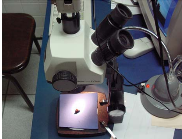
Microscopio de luz estereoscópico con cámara digital de video conectada al ordenador
