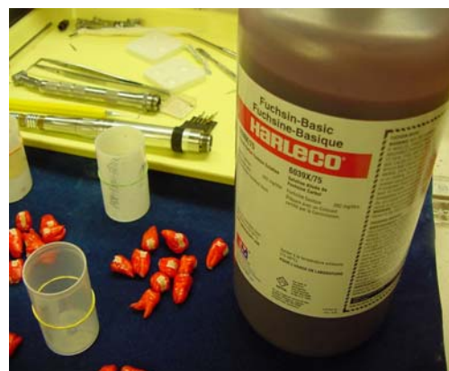
Se barnizaron las muestras y sellados los ápices con cera pegajosa se sumergen en fucsina básica.
