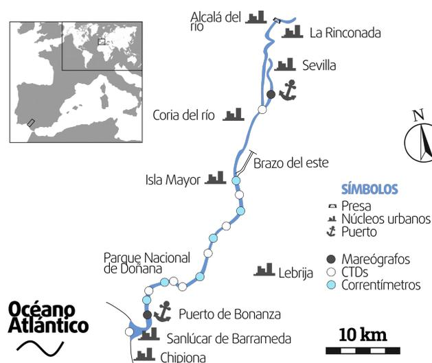
Fig. 3. Área de estudio: tramo bajo del río Guadalquivir. A lo largo del estuario se muestran los distintos dispositivos de medición que registraron variables meteocean durante el periodo de 2008 a 2010. En el subpanel se observa la localización del estuario.
