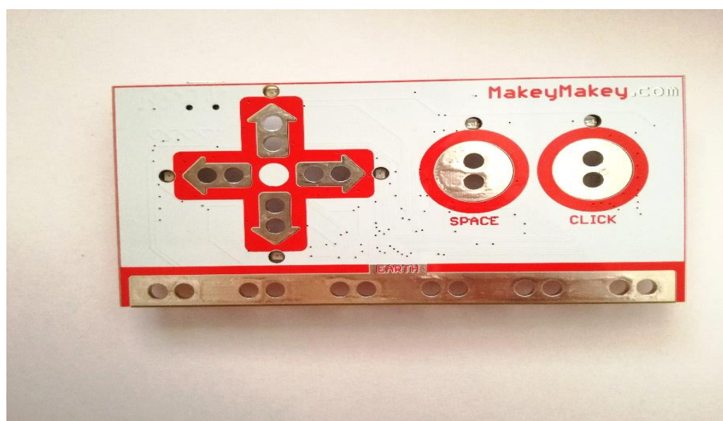
Figura 2. Placa de Makey-Makey.
