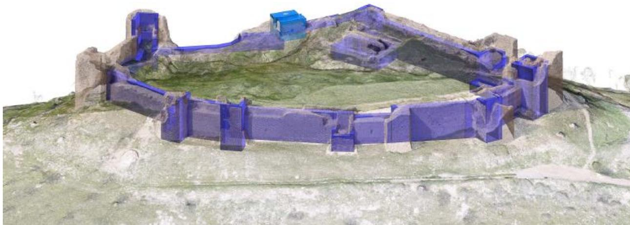
**Figura 25:** Modelado paramétrico de las estructuras correspondientes a la fase I en base a la inserción (vinculo) de la nube de puntos georreferenciada.
