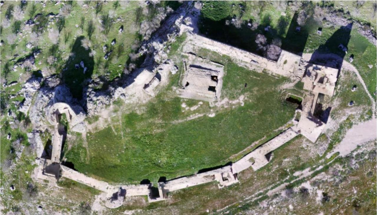
**Figura 2:** Vista en planta del castillo de Píñar. Ortophotografía a partir del modelo 3D realizado por fotogrametría SFM mediante UAV.
