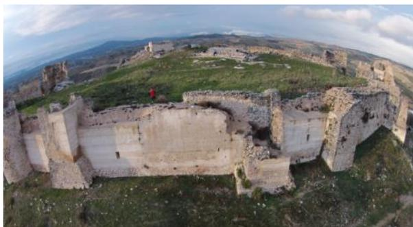
**Figura 7:** Imagen con importantes deformaciones radiales provocadas por la lente de la cámara FC200-Phantom2 visión-plus. FOV 110°.
