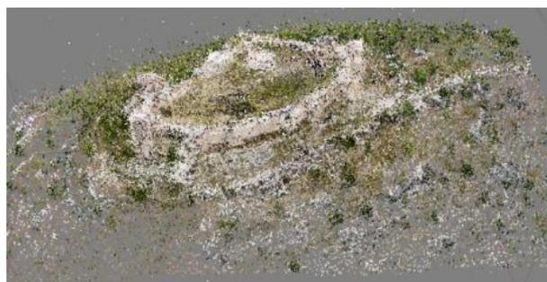
**Figura 10:** Vista en perspectiva de la nube de puntos discreta (puntos unitivos) del castillo de Píñar (33906 puntos).
