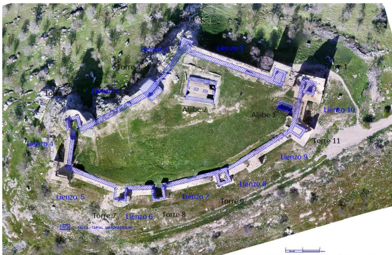
Figura 15: Dibujo de la fase 1: tapial de tierra sobre ortofotografía en planta del castillo.
