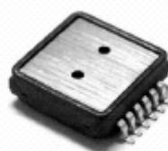
Figura 1.9. Termopila micromecanizada Bosch para detección IR de CO<sub>2</sub>.
