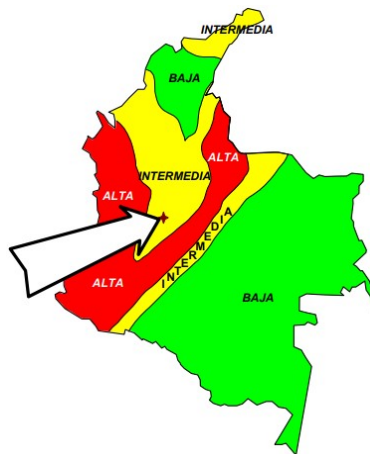
Figura 16. Representación esquemática ilustrativa del procedimiento de localización dentro del mapa de zonificación sísmica del Capítulo A.2
