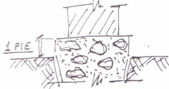
Figura 11. Cimentación Según Palladio (Análisis Patológico, Constructivo y Aplicación del Método Estratigráfico Murario en la Fachada Norte de la Iglesia Sto. Domingo en Murcia)
