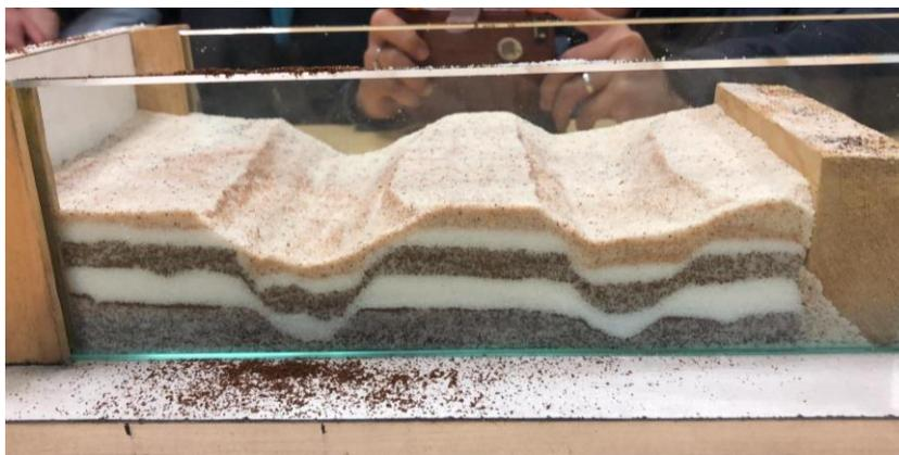
**Figura 6.** Simulación de falla normal con azúcar y colacao. Elaboración propia
