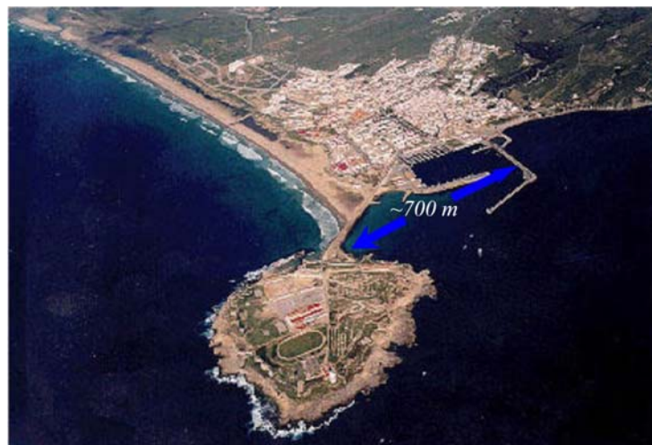
Figura 3-13: Fotografía aérea del puerto de Tarifa y alrededores. La configuración del puerto con la isla de punta Paloma permite ampliar la longitud total del mismo. De esta forma la onda estacionaria capaz de resonar también amplía su longitud de onda.
