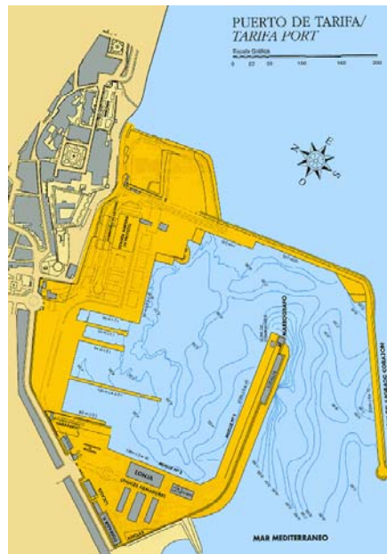
Figura 3-12: Plano del puerto de Tarifa, mostrando las dimensiones del puerto y su batimetría.
