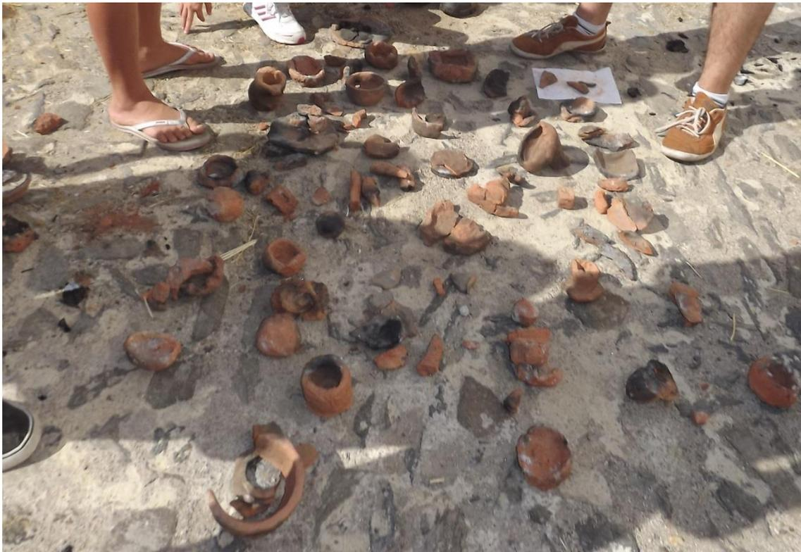
Fig. a.4 – Resultado de la cocción donde puede observarse las producciones finalizadas con éxito y aquellas que presentan fractura estructural y, por tanto, no son útiles para la función con que fueron diseñadas
