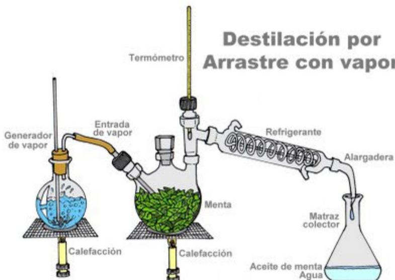
Figura 1.21. Ejemplo de montaje para el aislamiento del aceite de menta por arrastre de vapor.
