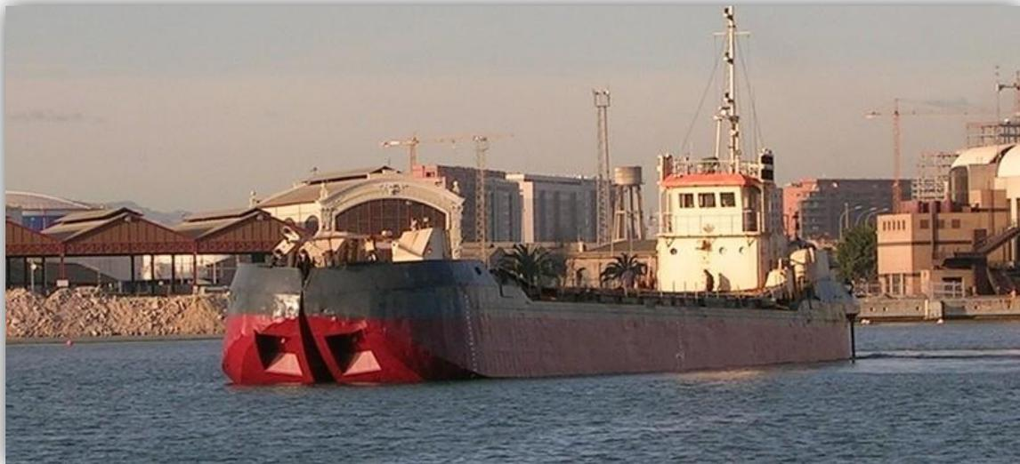
*Figura 29. Gánguil de apertura por fondo, convertible a draga mediante grúa-celosisia – ‘Cyes Maritime Works’*
