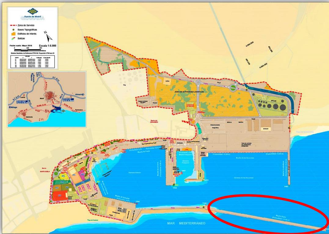
Figura 26. Plano del puerto de Motril, destacando el dique a ampliar – ‘AP Motril’
