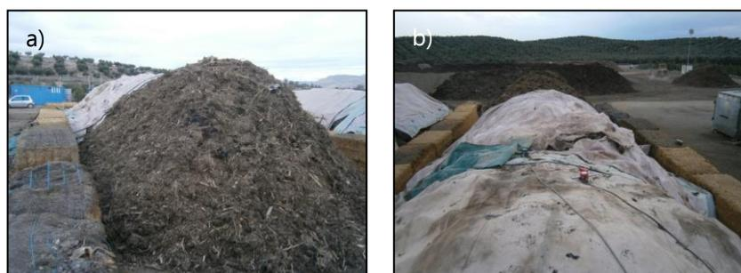
Figura 3.1. Imágenes del montaje de la pila en la planta de biosólidos "El Salao". Pila descubierta a) y pila con cubierta Gore-Tex® b).
