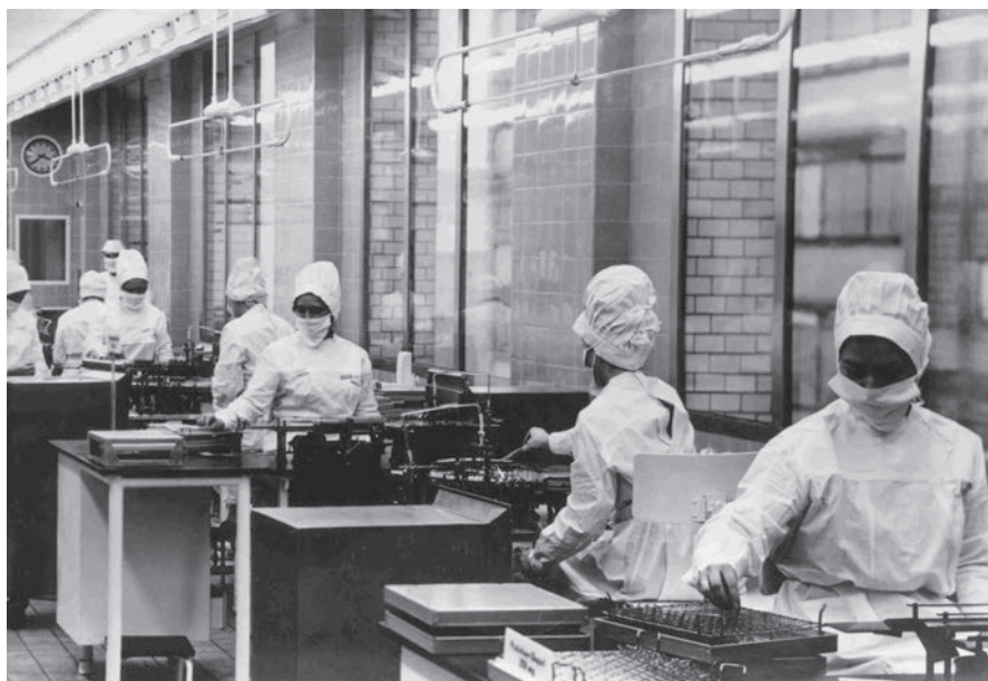
Fig. 3.—Trabajadoras relleno y cerrando a la llama viales en la fábrica de Schering en Berlín-Charlottenburg, ca. 1960. Archivo Schering, Bayer AG.
