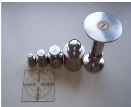
**Figura 33:** Extensómetro, vidrio graduado y juego de pesas.
