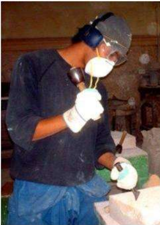
Alumno en el taller de cantería tallando una pieza en piedra.
