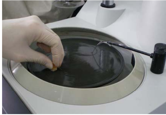
Fig. 6. Pulido de una muestra con papel abrasivo de SiC de 600-grit irrigado con agua.
