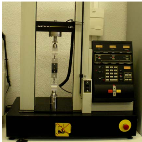
Fig. 24. Preparación del test de Shear Bond Strength usando la Máquina Universal de Ensayos Instron (modelo 4411)
