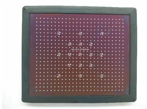
Figura 2.38. Objeto de calibración usado en el método DIC.
