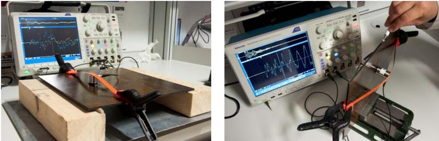
Figura 6.12. Disposición del ensayo para rotura de mina en la Probeta 1. Izq.: Rotura de mina en superficie (OP); Dcha.: Rotura de mina en canto (IP).
