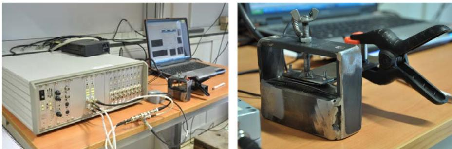
Figura 6.33. Vista del ensayo de delaminación pura.
