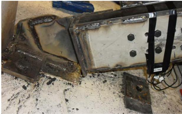
**Figura 3.14.** Detalle de la fijación soldada del disipador WPD a la chapa de sujeción entre los nudos viga-pilar en la estructura principal del edificio.
