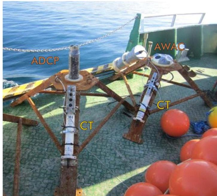
Figura 5.1: Tripodes con la instrumentación a colocar
