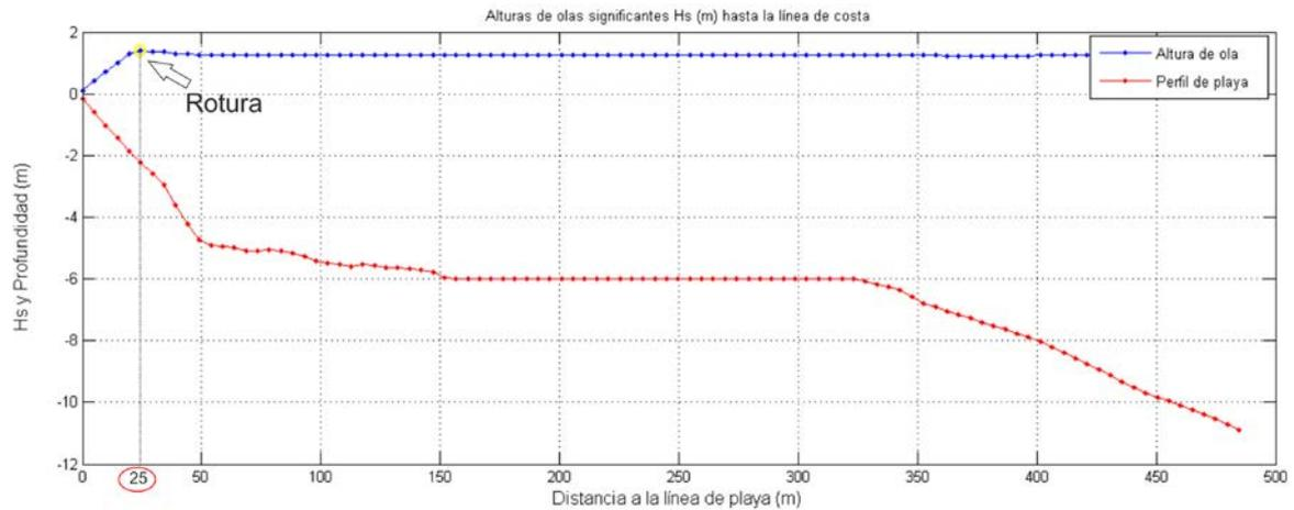
Figura 8.14: Punto de rotura de un oleaje de  $H=2.5m$  y  $T=8s$
