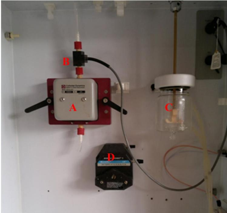
**Figura 4.4:** Fotografía del dispositivo Acoustosizer II. A: célula de medida. B: electrodo de medida de conductividad. C: Vaso para termostatar la suspensión. D: bomba peristáltica.
