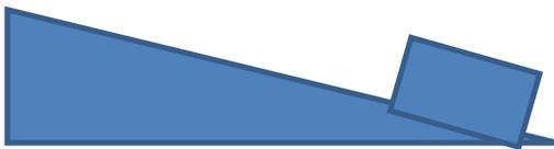
5. Si la cuerda de la figura soporta una tensión  $T$  máxima de 20 N, antes de romperse, explique si es posible usarla para jalar el bloque de la figura con movimiento acelerado a) sobre una superficie horizontal. B) sobre un plano inclinado  $35^\circ$ .  $m = 5 \text{ kg}$ .  $\mu = 0.3$  c) ¿hasta qué ángulo podría inclinarse el plano sin que se rompa la cuerda?
