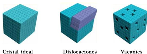
Figura 1.10. Representación de un cristal ideal y de los defectos más comunes que se producen en los cristales.<sup>77</sup>
