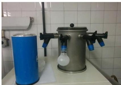
Figura 4.5. Equipo de liofilización utilizado para la síntesis de los materiales **COK-15@X**.
