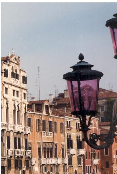
Figura 7.7. Farola de vidrio en Venecia que muestra el color lila probablemente debido a la progresiva fotooxidación del  $MnO$  a  $Mn_2O_3$ .
