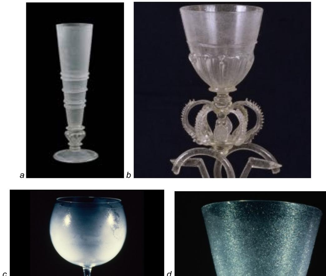
Figura 7.1. a), b), c) y d) Copas de vidrio afectadas por la formación de una segregación alcalina (crizzling) (8-20 cm alto). Corning Museum of Glass, Corning, NY, EE.UU.
