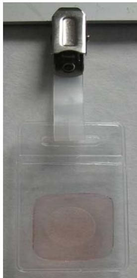
Figura 7.11. Sensor de acidez ambiental en una funda protectora provista de pinza.
