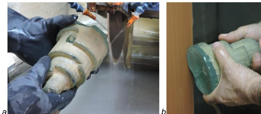
Figura 8.48. Etapas del acabado de la figura Babel obtenida mediante colado en molde abierto de arena. a) Corte de la rebaba de la base. b) Pulido de la zona recortada.
