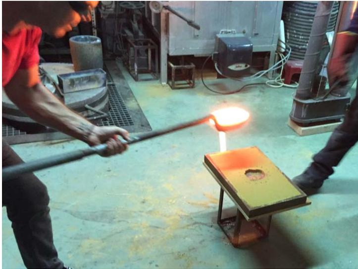
*Figura 3.24. Operación de colado de vidrio en un molde de arena.*
