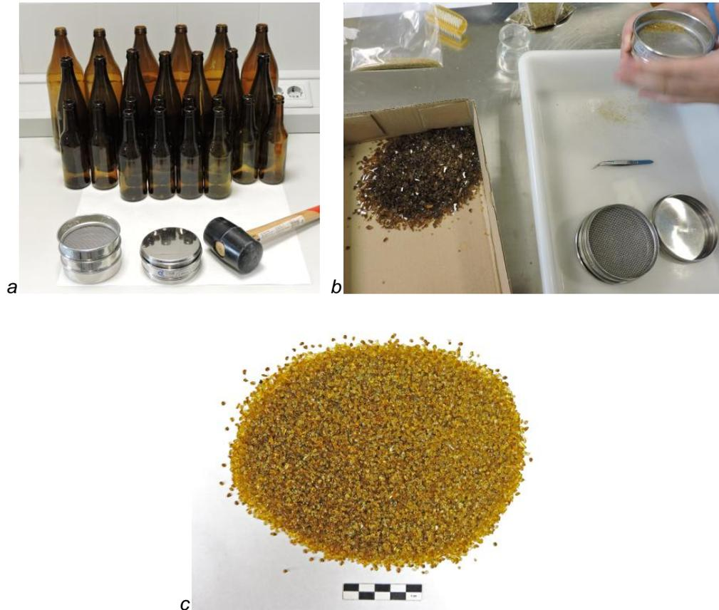
Figura 8.82. Proceso de preparación de la granalla del vidrio Ámbar. a) Botellas de partida. b) Tamizado tras la molienda de los fragmentos. c) Granalla tamizada.
