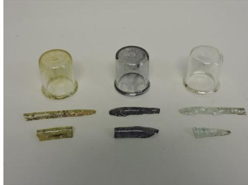
Figura 8.27. Ensayos de aplicación de tres lustres distintos en pequeños vasos de vidrio y en fragmentos de recortes de los vidrios de este trabajo.
