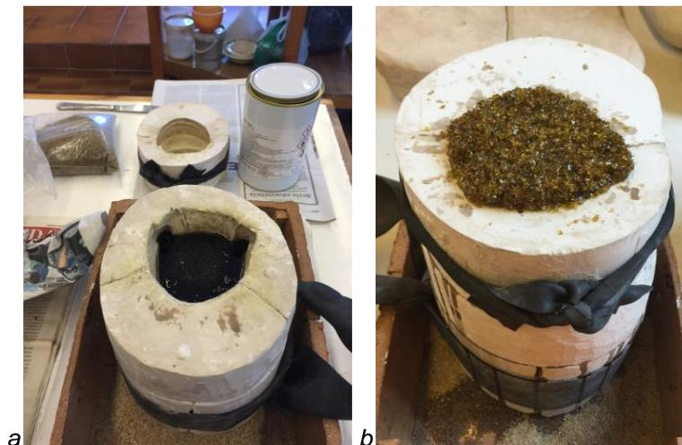
Figura 8.84. Compactación de la figura *Pascua*. a) Rellenado del fondo del molde con la mezcla de granalla del vidrio Ámbar y resina de poliéster. b) Molde completamente relleno.
