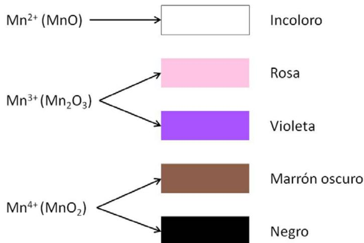
Figura 7.5. Colores producidos en los vidrios por el óxido de manganeso dependiendo de su estado de oxidación.
