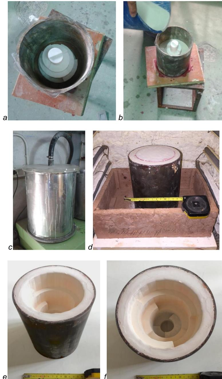
Figura 8.40. Etapas de elaboración del molde de Babel. a) Introducción del modelo en el anillo de acero. b) Rellenado del molde. c) y d) Sinterización del molde. e) y f) Aspecto del molde una vez eliminado el modelo.
