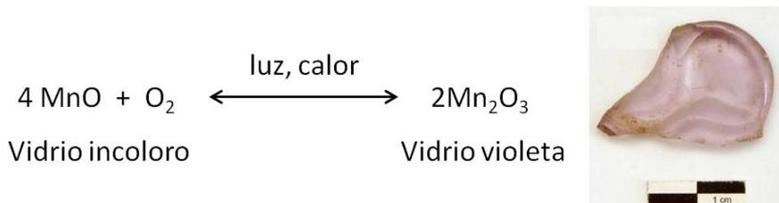
Figura 7.6. Reacciones de solarización en un vidrio incoloro de silicato sódico cálcico convencional con óxido de manganeso (oxidación fotoquímica).
