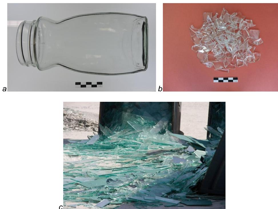
Figura 8.5. Vidrio Incoloro. a) Tarro, observación con luz natural. b) Fragmentos procedentes del tarro. c) Fragmentos procedentes de casco de vidrio plano común de ventana.
