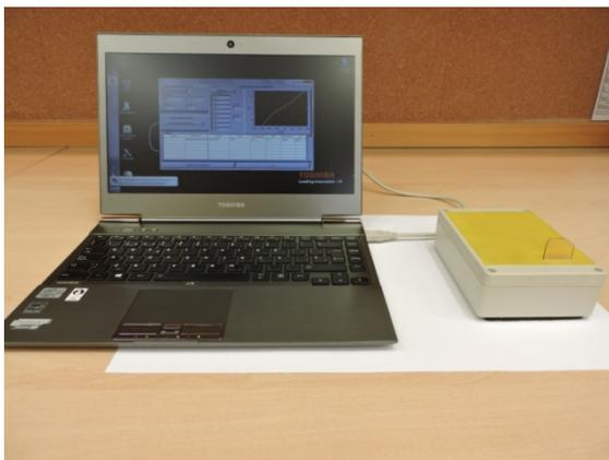
*Figura 7.12. Unidad de medida portátil, con un sensor insertado en su portamuestras (derecha de la imagen), conectada a un ordenador.*
