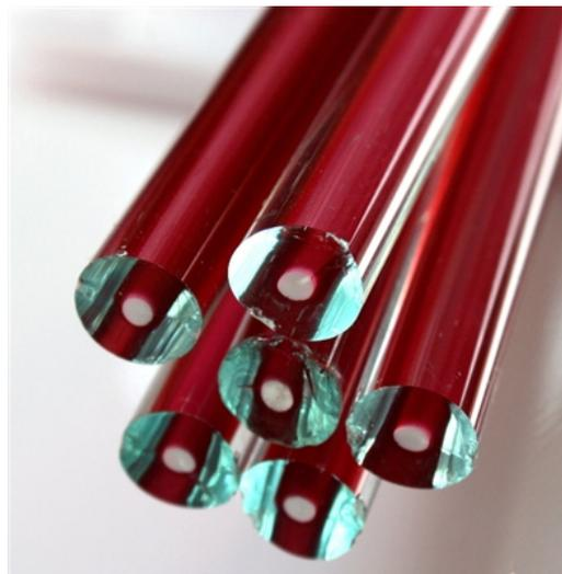
*Figura 3.39. Varillas de vidrio de partida para la realización de objetos de vidrio filigrana.*
