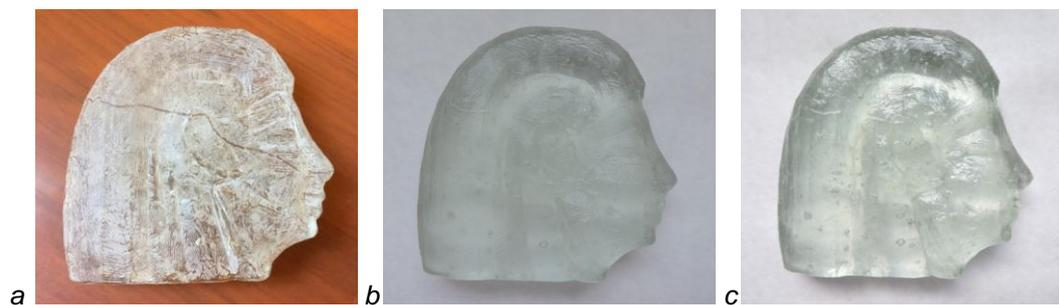
Figura 8.26. a) Relieve Nactanebo obtenido tras el termoconformado de fragmentos del vidrio Incoloro. b) Aspecto después de pulido al ácido fluorhídrico durante 20 min. c) Aspecto después de pulido al ácido fluorhídrico durante 80 min.
