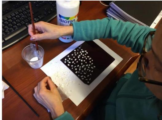
Figura 8.61. Fijación de las murrinas del vidrio Opal sobre la superficie limpia de la hoja del vidrio Rubí.
