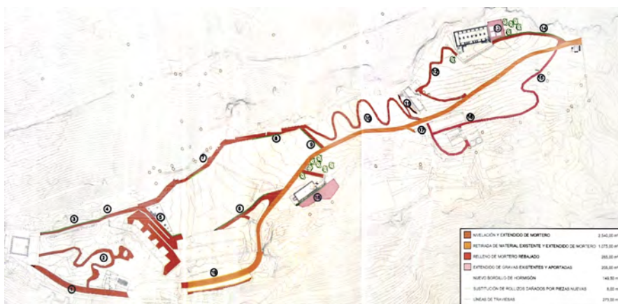
Fig. 162: Acondicionamiento de caminos. (Granados et alii , 2006)
