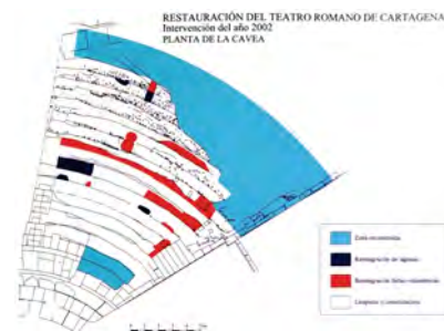
Fig. 116: Planta del teatro donde se señala los puntos de intervención de restauración en el año 2002. La leyenda señala con color azul celeste la zona reconstruida; azul marino la reintegración de lagunas; rojo la reintegración de faltas volumétricas; y en blanco el espacio en el que sólo se ha procedido a su limpieza y consolidación. (Ramallo et alii , 2002)
