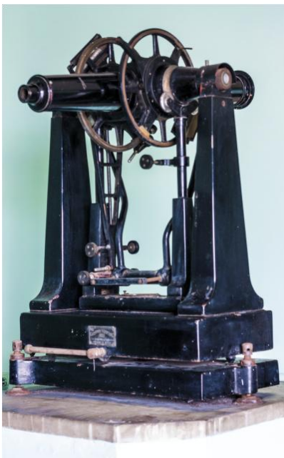
68. Telescopio Gaertner de pasos meridianos o Círculo Meridiano, fabricación norteamericana.
