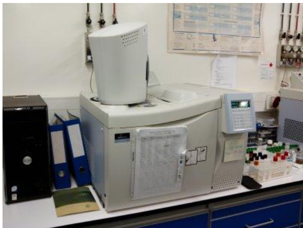
Figura 37. Cromatógrafo GC-FID, análisis azúcares neutros (elaboración propia).
