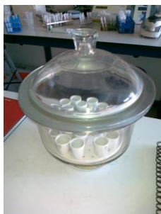
Figura 27. Desecador con crisoles de porcelana (elaboración propia)
