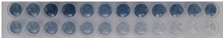
Figura 38. Ejemplo de realización del método Folin-Ciocalteu
