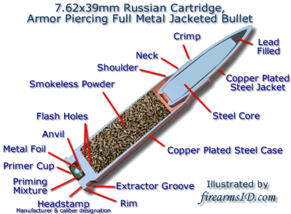
Figura 8. Esquema de munición de rifle <sup>11</sup> (7.62 x 39 mm)
