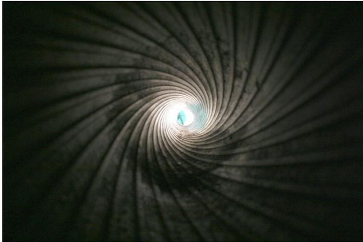
Figura 6. Vista del anima rayada al interior del cañón de un arma de fuego <sup>9</sup>.
