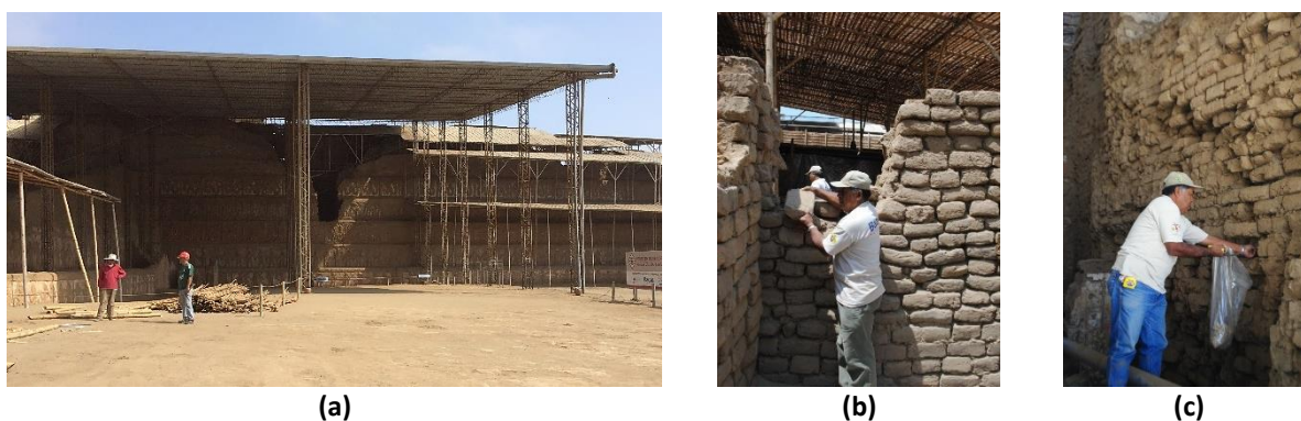
Figura 1. Vista general de Huaca de la Luna y sus paredes: (a) Fachada Norte, (b) bloques de adobe usados para la caracterización mecánica y (c) proceso de extracción del mortero.
