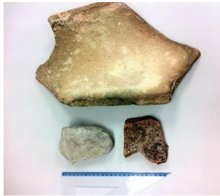
Figura 15. Toma de muestras de materiales empleados en la construcción de la obra, para su análisis.
