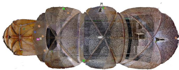
Figura 7. Vista perspectiva cónica aérea de la nube de puntos una vez registrada
