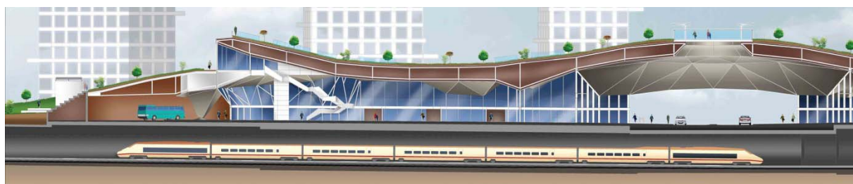
Figura 4. Sección longitudinal de la estación de autobuses proyectada y cajón FFCC existente (ejecutado Fase I).
