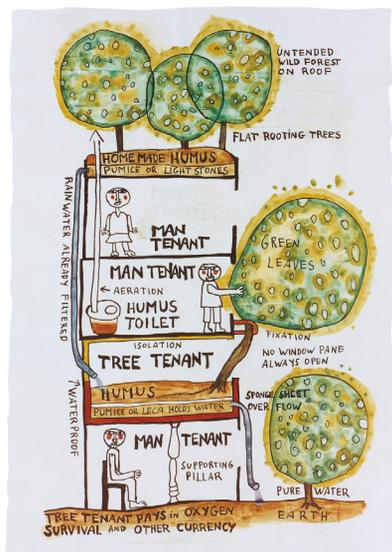
**Figura capIII-4** Esquema dibujado por Hundertwasser en el que se muestran los *aseos de humus* (Munich 1975) con el ciclo de reciclaje de los residuos orgánicos de la vivienda para alimentar el sustrato del jardín en cubierta, en el espacio público adyacente y al árbol inclinado.
