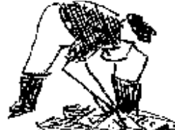
se alisa la superficie cuidando de recoger el exceso de barro
