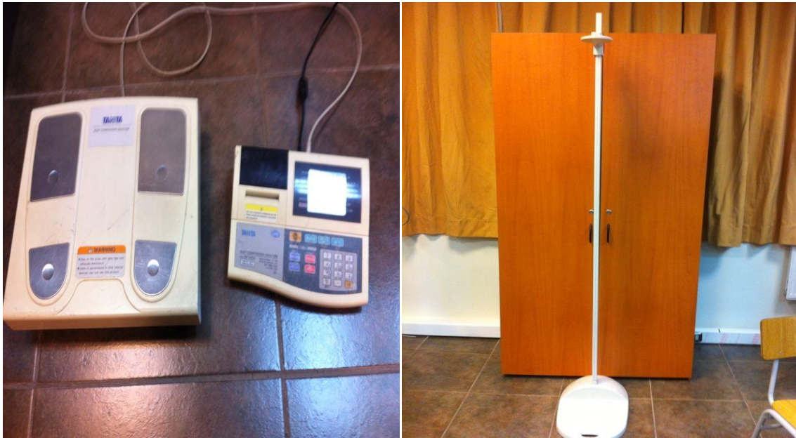
Figura 2C. Balanza digital (Tanita TBF 300 a , Japón, 2010) y tallímetro (Detecto 339, hecho en USA). Laboratorio de Fisiología del Ejercicio. Universidad de las Américas, Chile.
