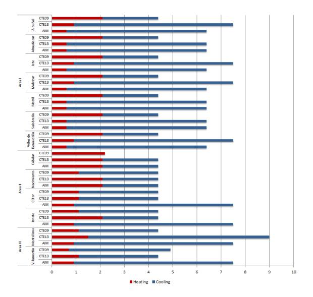
Fig. 26.  $CO_2$  emissions (kg  $CO_2/m^2$  per year).
