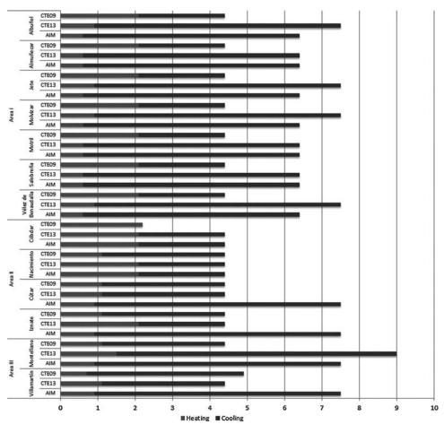
Fig. 7.  $CO_2$  emissions (kg  $CO_2/m^2$  per year).
