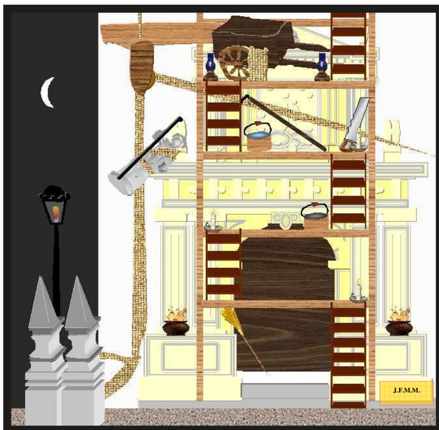
Andamio como el que pudo haber para la fachada del Carmen.
